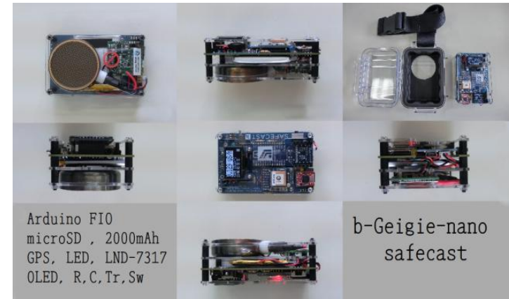
B-Geigie-nano: Eigenbau Geigerzähler (Projekt Safecast)
